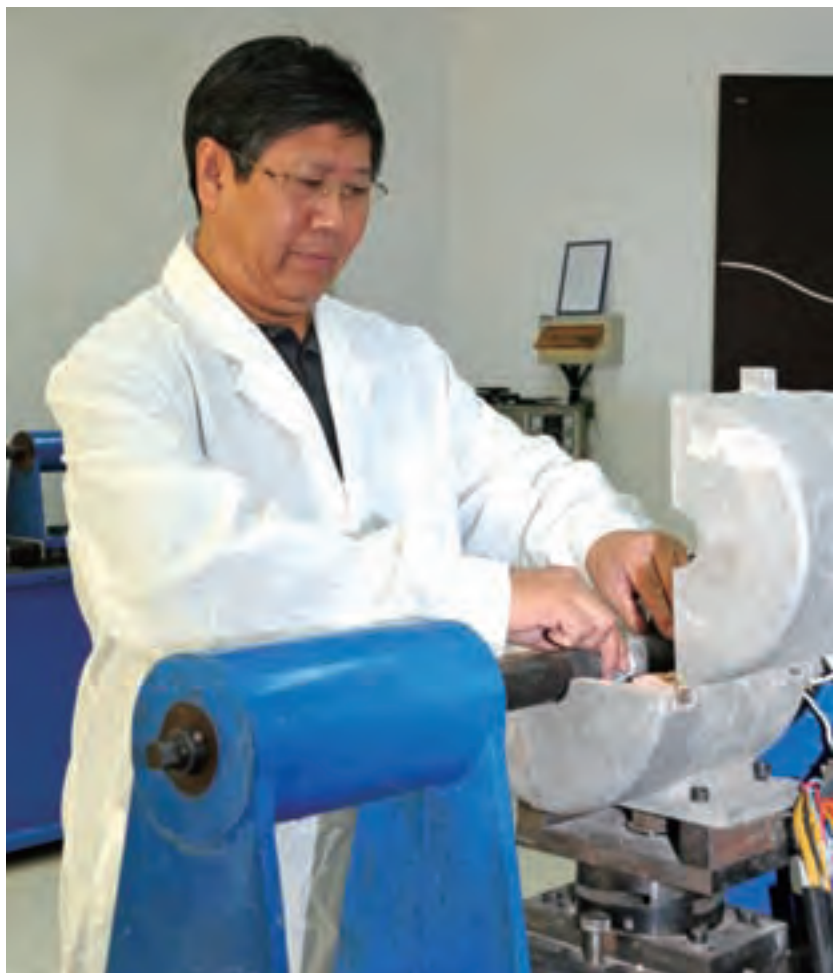
李国恩在进行倒像器扭转工艺试验
