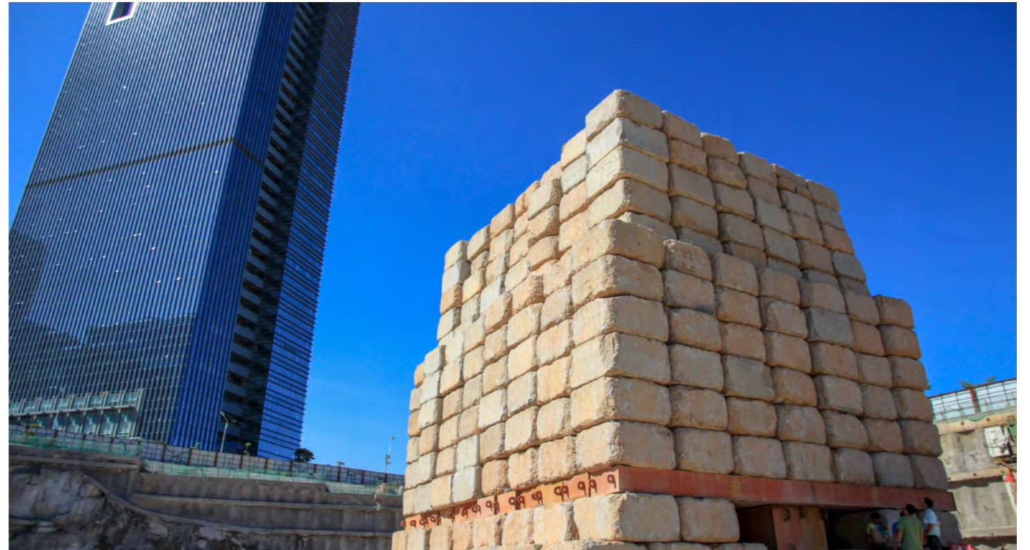
CTC 厦门宏业有限公司静载桩检测现场
